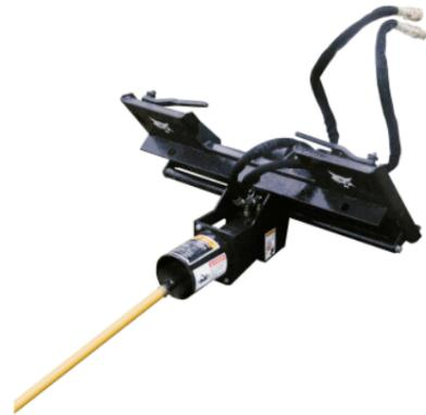
Poupe o tempo e as despesas da demolição de calçadas, entradas de garagem e outras áreas pavimentadas para instalar linhas de irrigação ou cabos de energia e comunicação. O acessório hidráulico perfura horizontalmente para a instalação de canos ou cabos com até 10 cm de diâmetro. Após a perfuração, o acessório pode puxar o cano ou cabo pelo buraco.
