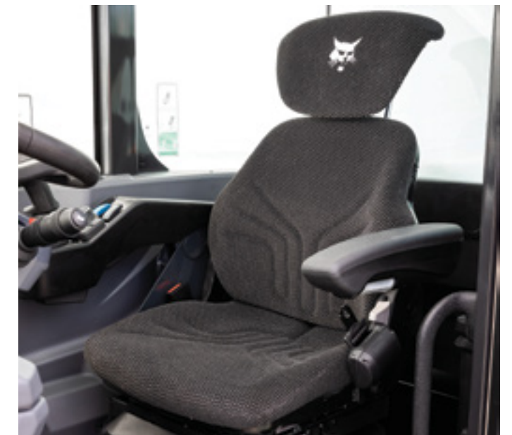
Asiento suspendido de aire Grammer Maximo con calefacción, DDS (Sistema de descarga dinámica) y joystick montado en descansabrazos suspendido
