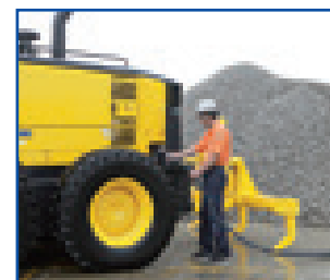
Abastecimento ao nível do solo
