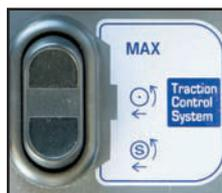
Além desses benefícios, o esforço máximo de tração pode ser ajustado em três níveis (máquinas convencionais permitem somente um nível) pela aplicação do interruptor de controle de tração. Isso permite ao operador selecionar o esforço de tração mais adequado conforme as mais variadas condições de solo.
