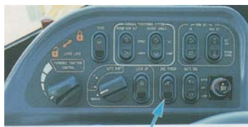
Interruptor de seleção de potência do motor em dois modos
