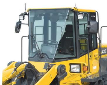
Um amplo vidro de superfície plana e sem colunas permite excelente visibilidade frontal. O braço do limpador cobre uma área extensa, possibilitando boa visibilidade mesmo em dias chuvosos. A área da cabina é a mais espaçosa da categoria, garantindo o máximo de conforto para o operador.
